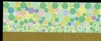
GAINAは、特殊セラミック層で構成されています。この特殊セラミックが、周辺温度に適應する性質を持つためその結果、熱の均衡化をもたらす、熱の移動を抑える働きをします。
