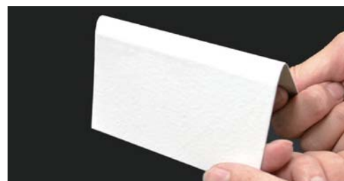
▲ 超低汚染リファインシリーズを塗布した鉄板を折り曲げた様子
