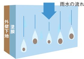
親水性が高いため、雨水が塗膜と汚れの間に入り込み、汚れが落ちる
