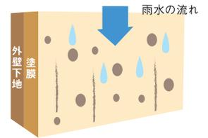
親水性が低いと汚れは流れ落ちにくい間に入り込み、汚れが落ちる
