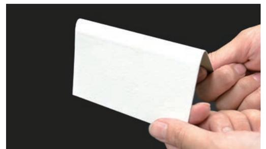
▲ 超低汚染リファインSi-IRを塗布した鉄板を折り曲げた様子
