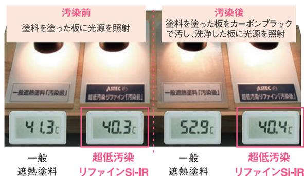
4枚の板に同量の光源を照射したところ、超低汚染リファインSi-IRを塗った板は、汚染前・汚染後でほぼ温度差がなく、遮熱性が維持されていることが実証されました。※1 社内試験にて実施
